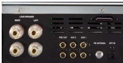
Anschlussfreudige Rückseite, sowohl für Analog- als auch Digitalquellen, ordentliche LS-Anschlüsse
